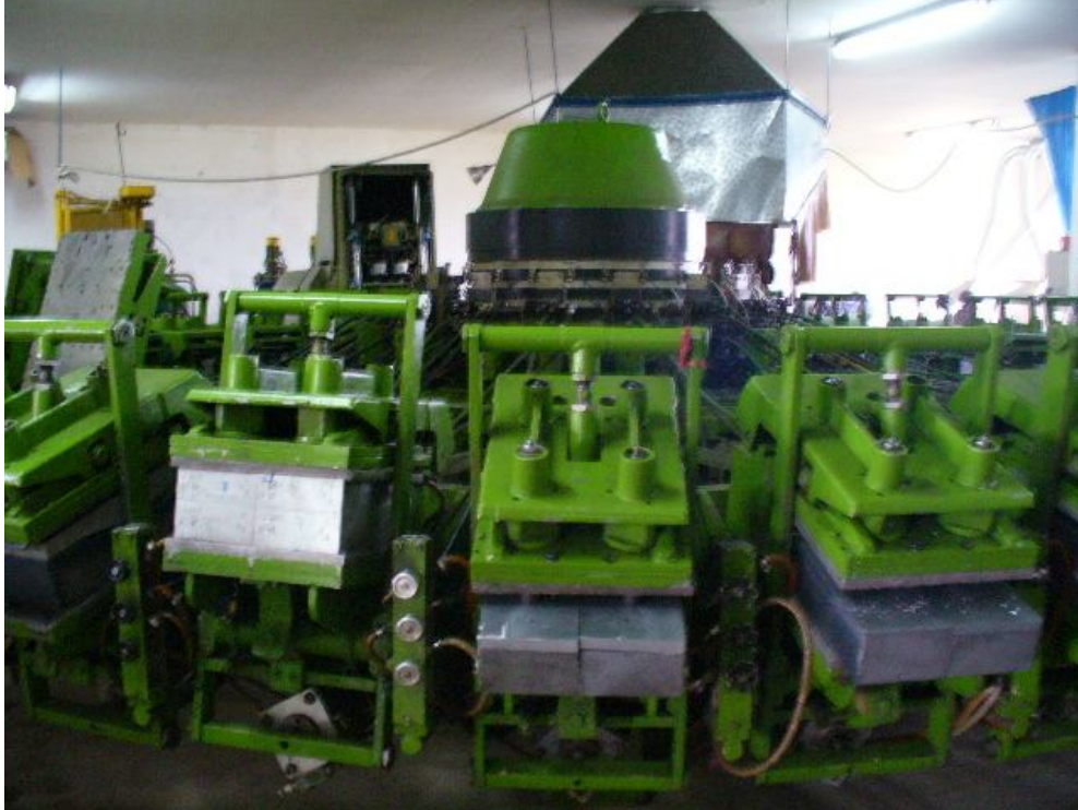
Photo 13. Les machines pour l'injection de la semelle (Photo: Scroccaro, 2008)
