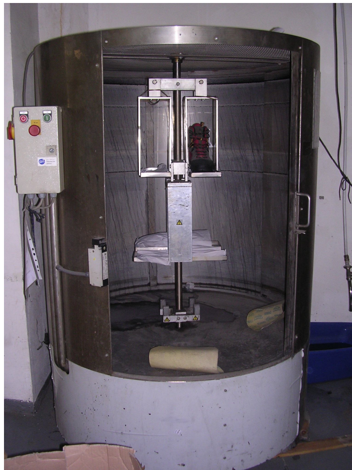
Photo 17. Une machine pour tester l'imperméabilité des chaussures (Photo: Scroccaro, 2008)
