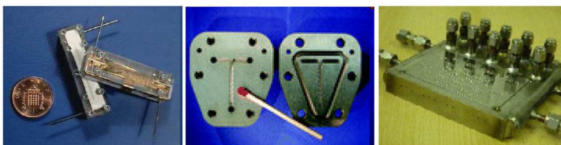
Figura 15. Esempi di microreattori in acciaio 4 .
