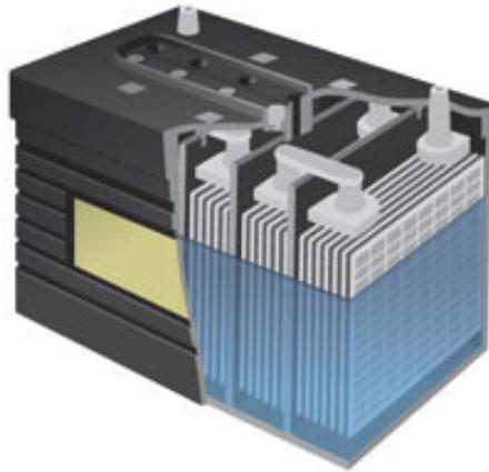
Figura 2.33: **Batteria Nichel-idrogeno.**
