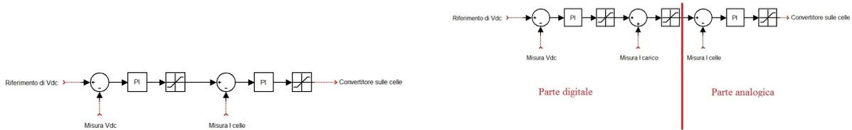
(a) Schema di principio del controllo estrapolato.
