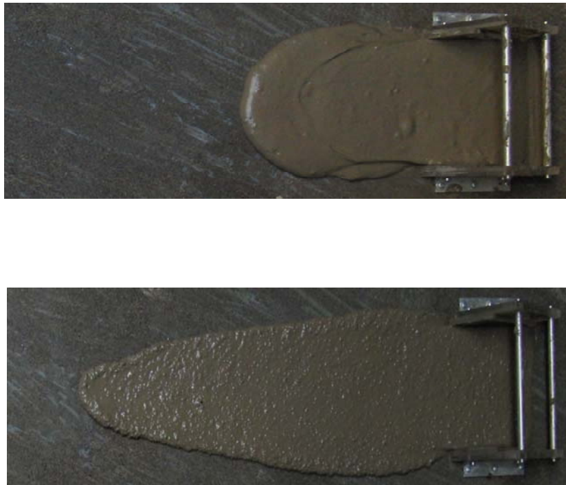
Figura 6.5 : tipica configurazione finale della colata: a) campione 1, W=58% ; b) campione 3, W=36%.
