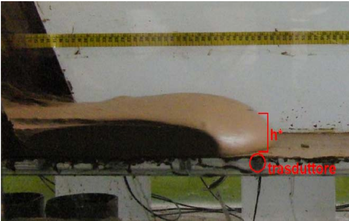
Figura 6.41: altezza del fronte di colata, h^* , in corrispondenza del trasduttore
