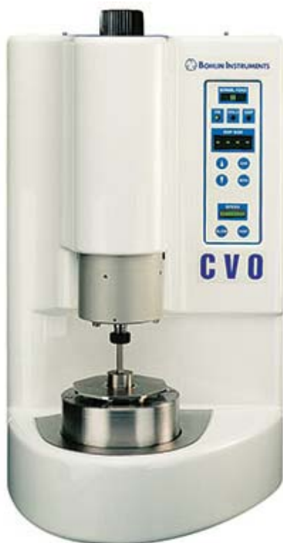
Figura 5.25 : reometro Bohlin C-VOR 120
