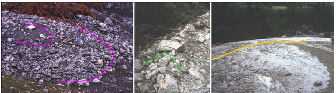
Figura 3.18: Morfologie osservate in campo relative alle tre classi proposte da Ancy (1999): da sinistra a destra viscoplastico, collisionale-frizionale e frizionale-viscoso (da Bardou, 2005).
