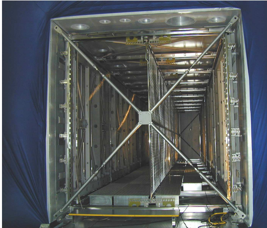
Figura 1.2: Interno di ICARUS T300: è evidente la suddivisione nelle due TPC mediante il catodo centrale.
