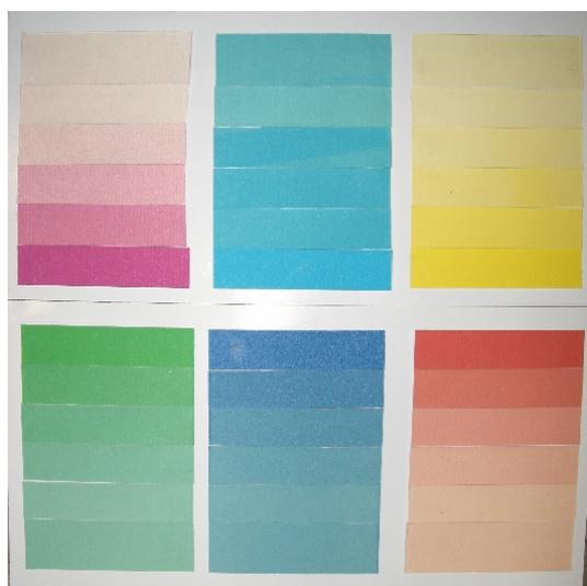
Fig. 68: Aspetto dei provini di inchiostro da stampante durante la prova INT\_1: a partire dalle strisce centrali più sature (tinta originale), ogni porzione corrisponde nell'ordine a campionamenti dopo 6, 18, 27, 39.5, 65
