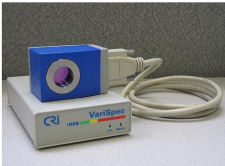
Fig. 22: filtri a cristalli liquidi sintonizzabili (LCTFs) con relativa centralina di comando tramite segnale elettronico da PC, marca CRI mod. VariSpec™ VIS
