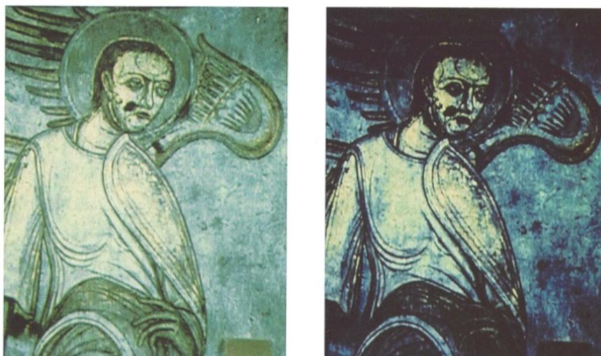
*Fig. 41: Immagine digitale di una foto in fluorescenza UV prima (a sinistra) e dopo (a destra) la ri-elaborazione per la pulizia della componente radiante parassita emessa dalle sorgenti UV [15]*
