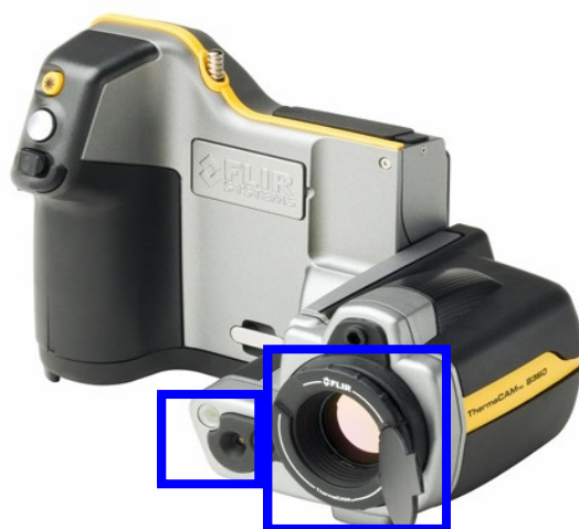
Figura 6 1 – Camera termica Flir B360. Nei riquadri blu sono evidenziati i due obiettivi, per l’acquisizione nel visibile a sinistra e per l’infrarosso a destra.
