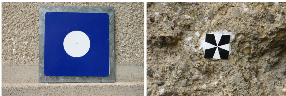
Figura 3 1 – Target laser scanning retroriflettenti Leica HDS 2500 (7.5 x 7.5 cm) a sinistra e fotogrammetrici (1 x 1 cm) a destra.
