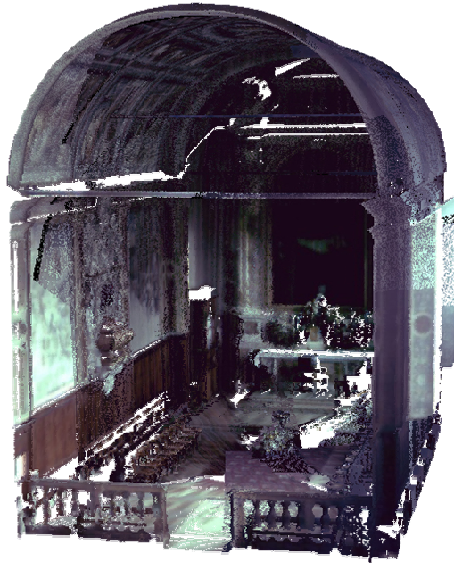
Figura 7 3 – un'immagine delle nuvole di punti che costituiscono il modello globale della Cappella. I colori presenti nel modello sono dati dalla diversa riflettanza dei materiali al segnale del laser.
