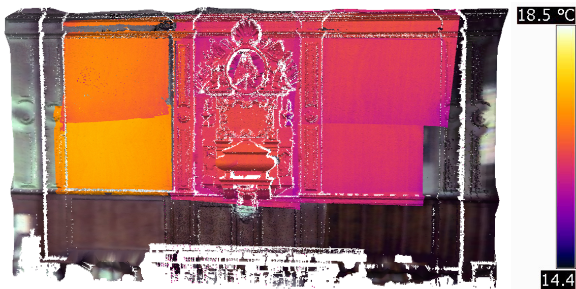
Figura 7 5 – mesh della parete senza finestre texturizzata con le immagini all'infrarosso. A destra la scala termo-colorimetrica.
