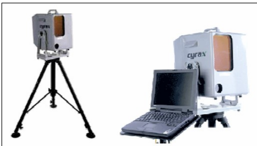
Figura 1 3 – due immagini dello scanner laser HDS 2500. A sinistra esso è stato montato sul proprio treppiede. Nell'immagine a destra è ben riconoscibile la finestra dalla quale esce il fascio laser, mentre dall'oblò inferiore il segnale viene raccolto e analizzato dal CCD.
