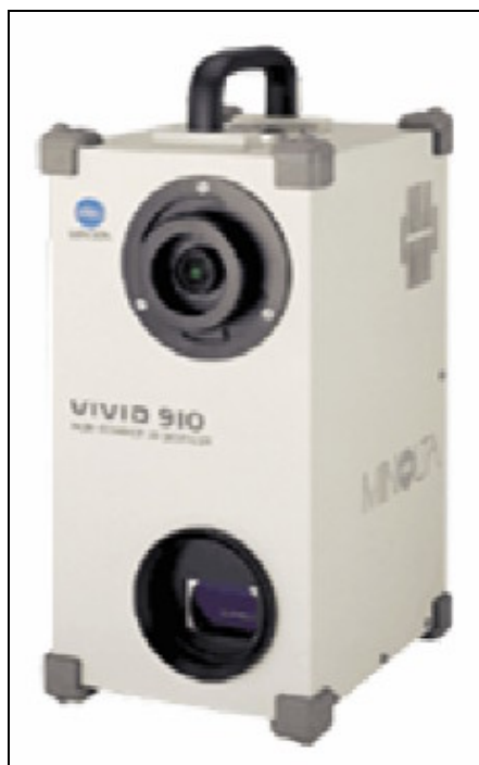
Figura 1 4 – un'immagine dello scanner laser Vivid 910. Dall'oblò inferiore è proiettato il fascio laser, mentre in quello superiore è ricevuto il segnale di ritorno dalla superficie dell'oggetto indagato.
