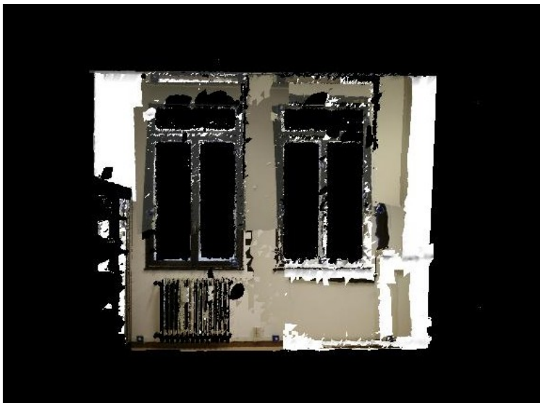
Figura 4 20 – Texturizzazione della porzione interna della parete chiusa con immagini acquisite nel visibile.
