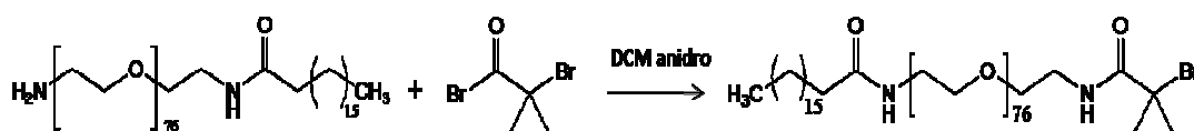
Figura 28: Schema di reazione tra NH 2 -PEG-stearil e bromo-isobutirrilbromuro in presenza di TEA
