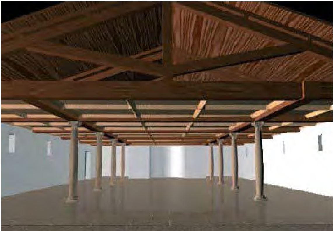
Fig. 3. Reconstrucción de la techumbre con tejado a dos aguas y falso techo plano al interior (BOTELLA y SÁNCHEZ, 2008: 32)
