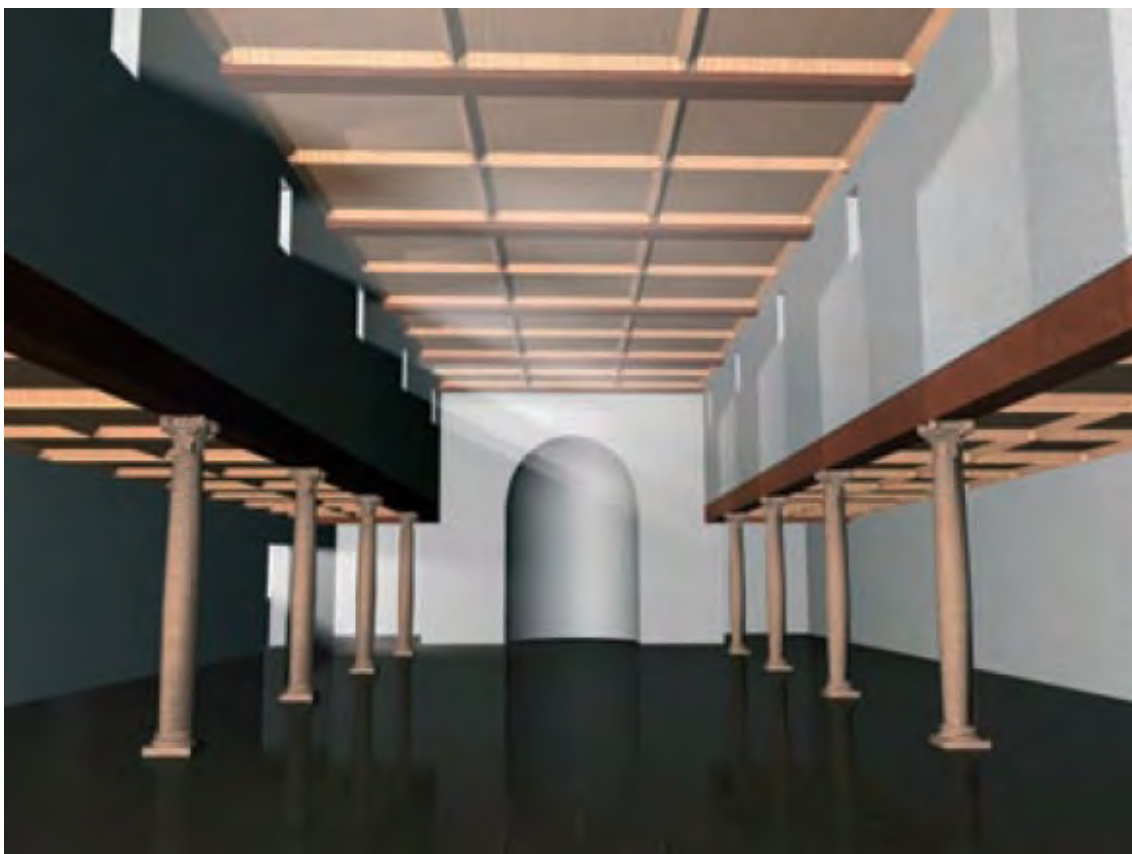
Fig. 4. Reconstrucción de la techumbre con nave central elevada (BOTELLA y SÁNCHEZ, 2008: 34).
