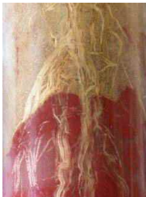
Figura 12 - Radici di erba medica nel trattamento T29L15 (replica 5) presenti all'interfaccia di separazione a fine prova (4 agosto 2004).
