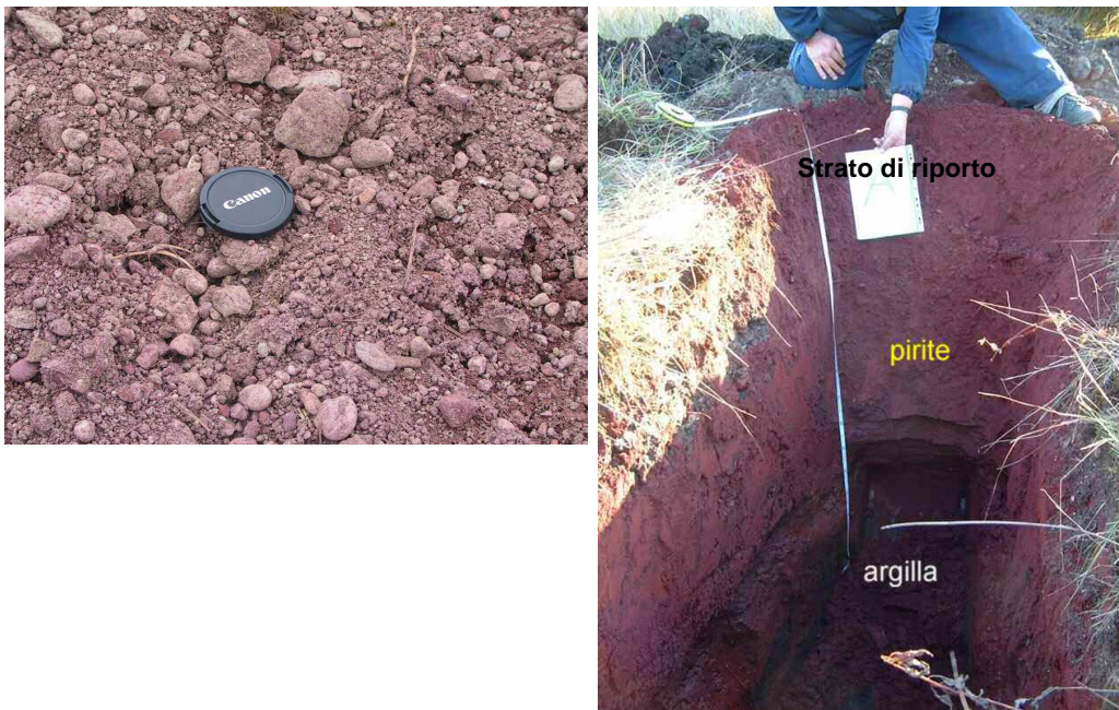
Figura 29 - Strato di riporto ricco in scheletro eterometrico frammisto a pirite, zolfo e terriccio (sx); stratigrafia del terreno, scavo del 17 dicembre 2003 (dx).
