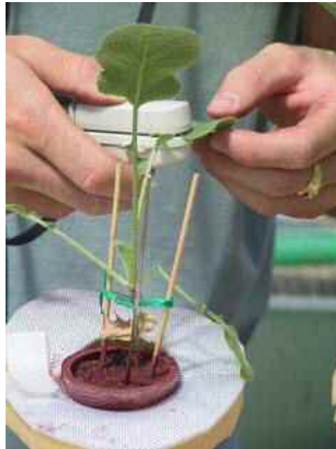
Figura 10 - Rilievo su foglia di rafano con SPAD. Momento della pinzature e lettura dei dati.
