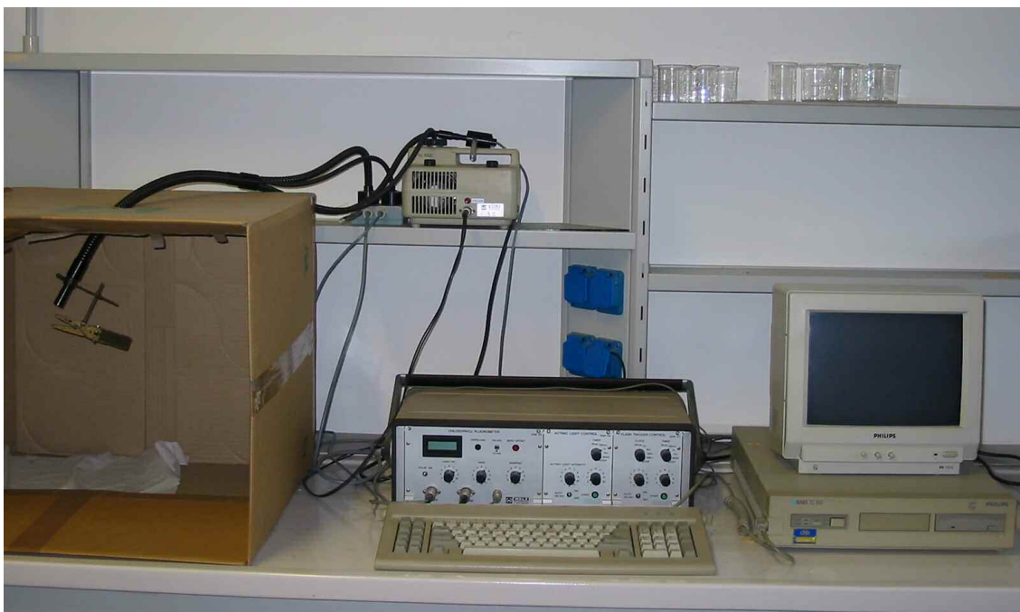
Figura 11 - Fluorimetro modello Walz KL 1500. Sulla sinistra l'emettitore, al centro l'unità di controllo e sulla destra il PC per le elaborazioni.
