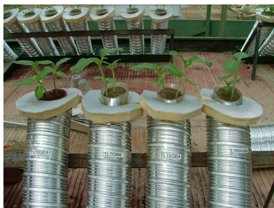
Figura 7 - Girasole (repliche 4) si possono vedere i tubi di acciaio di coibentazione ed il materiale sintetico spugnoso di copertura.
