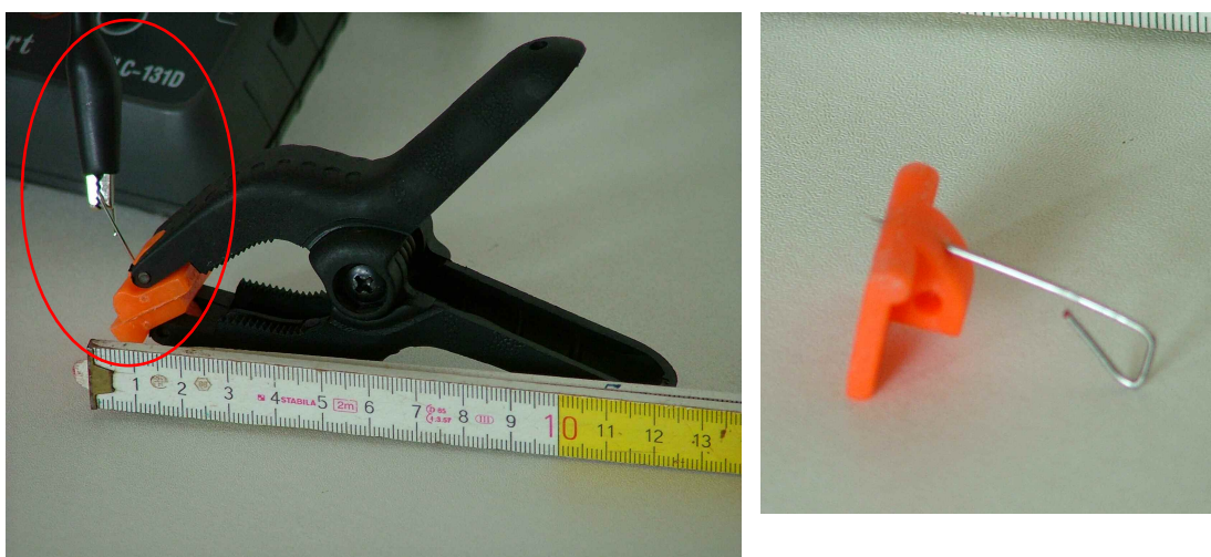
Figura 26 - Elettrodo negativo utilizzato nel metodo indiretto “elettrico” per le piante arboree. A destra un particolare dell’ago.
