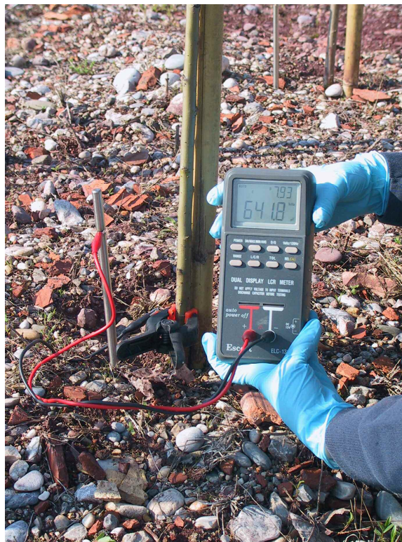
Figura 28 - Capacimetro; sulla sinistra l'elettrodo positivo inserito nel terreno, mentre sulla pianta la pinza che consente l'inserimento dell'elettrodo negativo.
