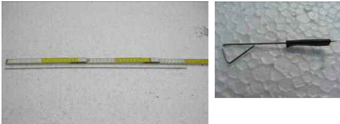
Figura 15 - Elettrodi utilizzati nel metodo indiretto “elettrico” per le piante erbacee in vaso. A destra l’elettrodo positivo, a sinistra quello negativo.
