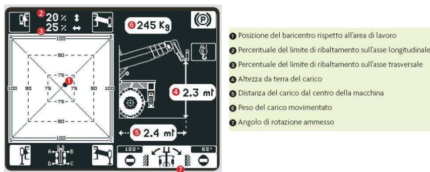
Figura 2.11: Visualizzazione grafica del baricentro sui sollevatori Roto 4025 [40].
