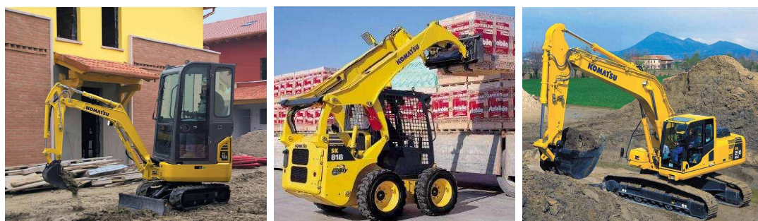
Figura 1.3: A sinistra un esempio di Miniescavatore; al centro un esempio di Pala Compatta; a destra un esempio di Pala Cingolata [2].
