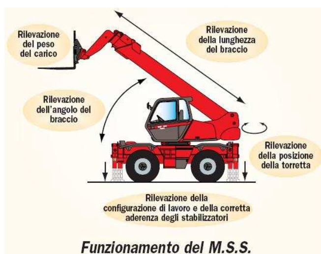
Figura 2.9: Manitou Safety System, sistema per il controllo di stabilità [41].
