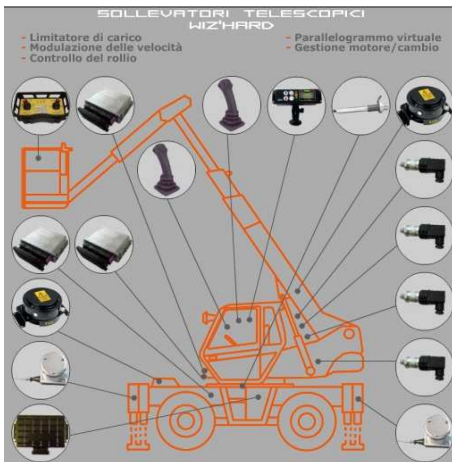
Figura 10.6: Distribuzione della sensoristica per un sollevatore telescopico fornita da 3B6.
