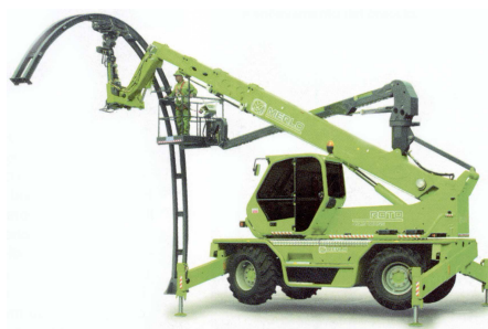
Figura 2.6: Applicazione di un Sollevatore Telescopico in galleria [40].
