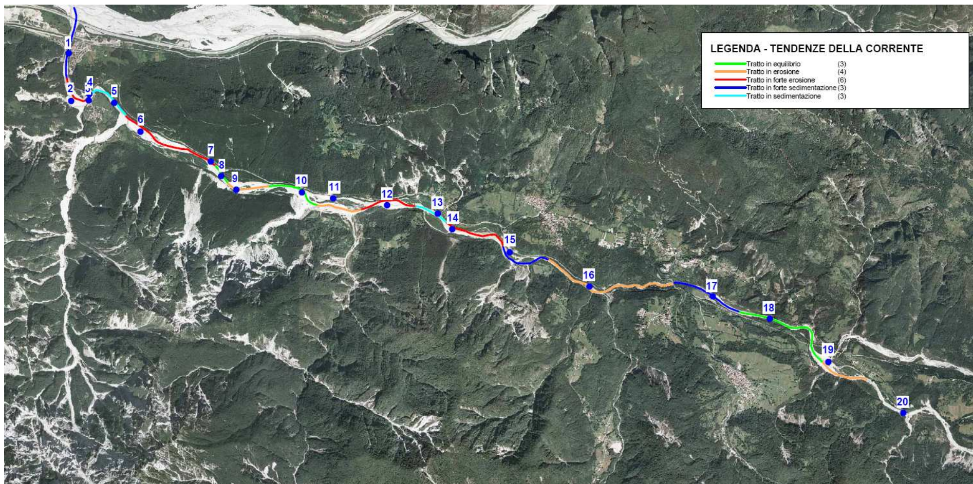
Figura 84: Carta della tendenza evolutiva sulla base del valore dell'asimmetria delle curva granulometriche.
