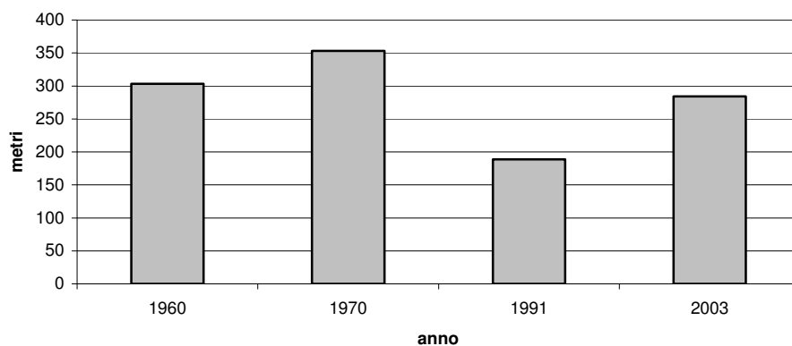
Figura 4.38 - Variazione larghezza media alveo attivo (canali e barre) delle sezioni relative al sottotratto 4 nell'intervallo temporale 1960-2003
