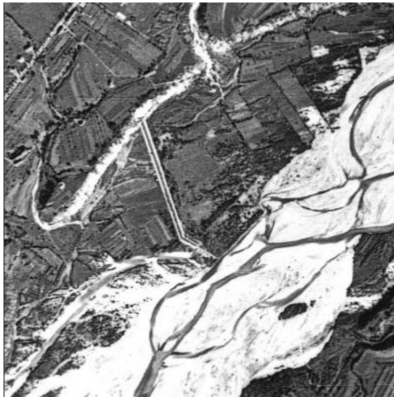
Figura 4.68 – Foto aeree del sottotratto 4 del 1954. In destra idrografica è visibile il pennello protettivo.
