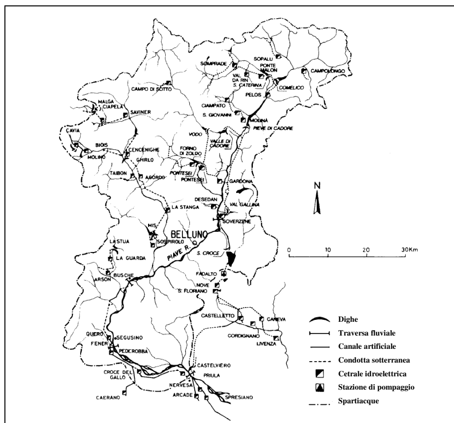
Figura 3.3 - Schema delle opere elettro-irrigue del fiume Piave (Da Surian, 1999 modificato)
