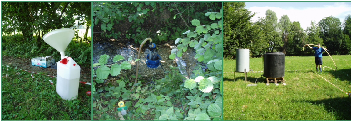
Figura 4.14: Iniezione del tracciante salino nel pozzetto GP6.
