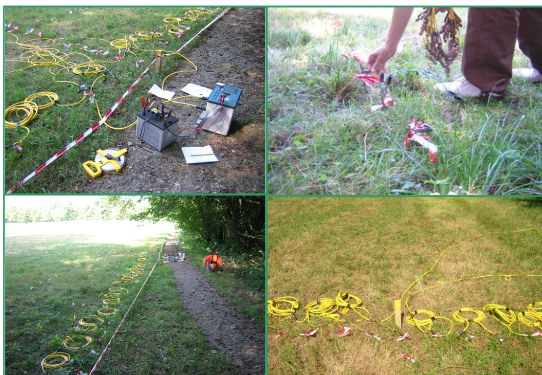
Figura 4.12: Strumentazione utilizzata per l'acquisizione dei dati di resistenza: cavi ed elettrodi.
