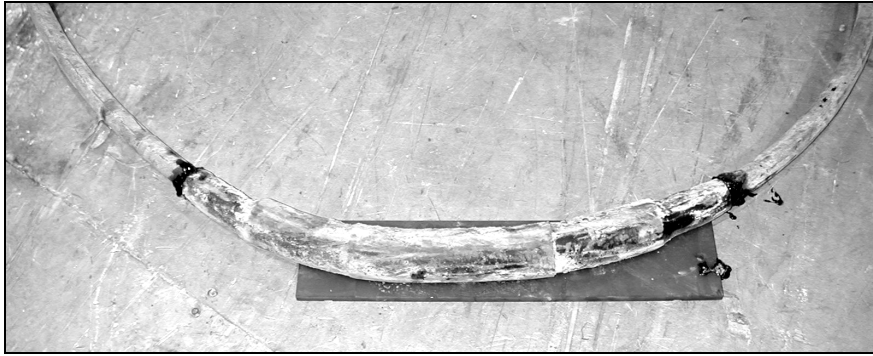
Fig. 7.2 - Dettaglio del giunto con difetto artificiale
