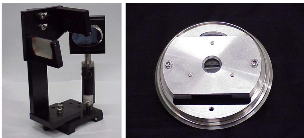
Figura 3.9: Gli elementi del banco ottico: a sinistra il sistema di specchi all'uscita del monocromatore, a destra la fenditura utilizzata per la calibrazione spettrale
