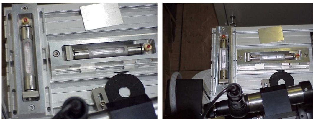
Figura 3.11: L'allineamento del banco ottico: a sinistra le bolle non centrate, a destra posizione delle bolle quando il banco ottico è allineato con l'orizzontale
