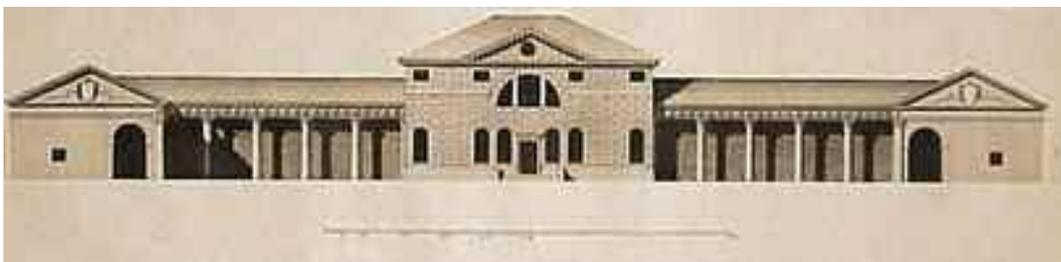
Si tratta di una delle tre sole ville che l'architetto progettò nel territorio trevigiano. La costruzione è posta su di un alto basamento, voluto espressamente per proteggerla dalle acque durante le frequenti esondazioni del fiume Piavon.
