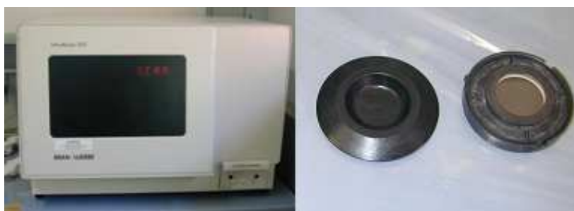
Figura 3.7. InfraAlyser500 (Bran+Luebbe) e sue dotazioni (tazzina aperta e tazzina chiusa)
