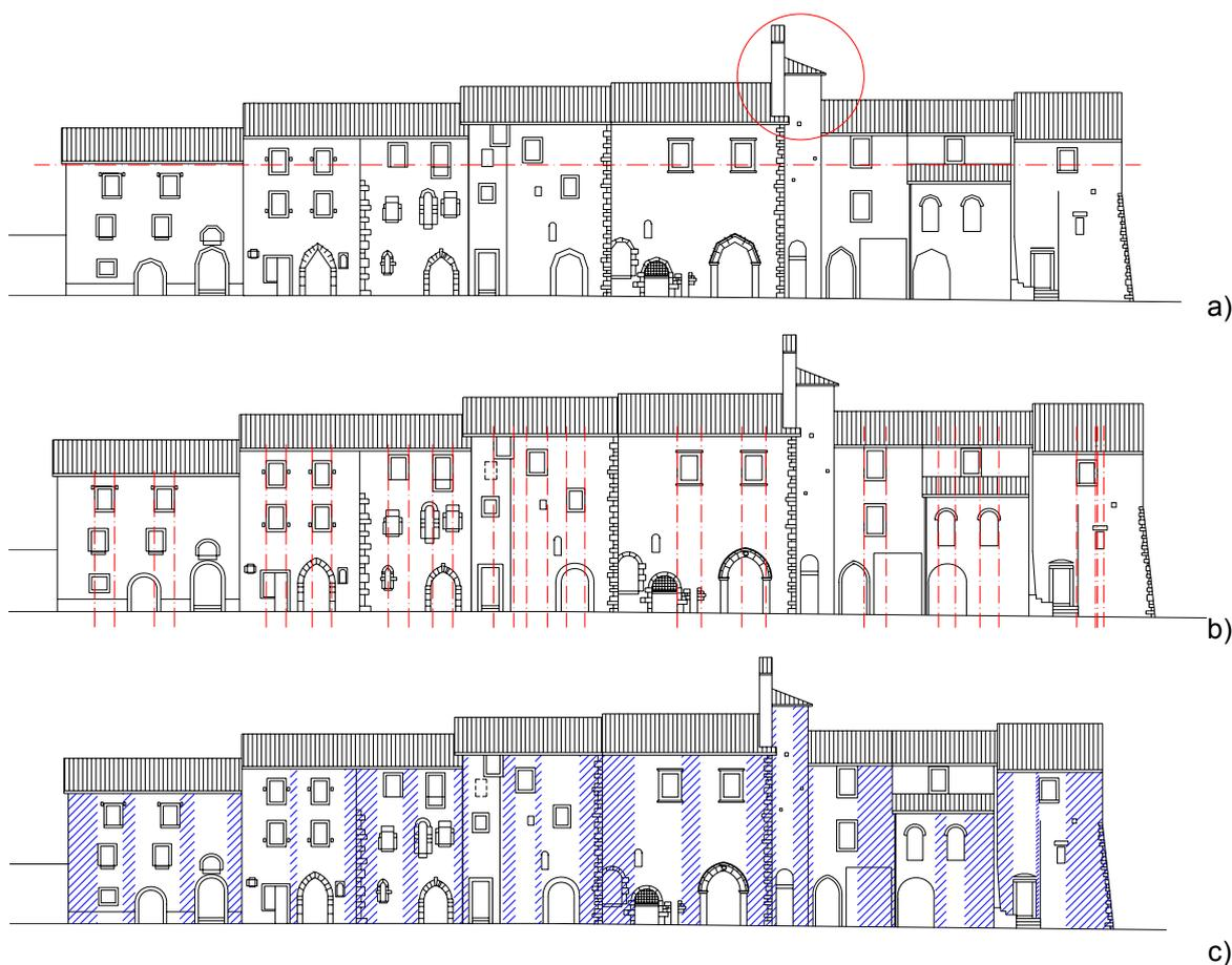
**Figura 1.8 – Analisi di alcuni elementi di vulnerabilità della schiera 5 del Centro Storico di Campi Alto di Norcia (PG) eseguite dal Politecnico di Milano: a) irregolarità altimetriche; b) irregolarità nella distribuzione delle aperture; c) conseguente riduzione di spessore dei maschi murari (Cardani, 2003).**
