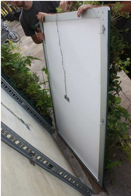
Figura 17 – Sonde sul retro del pannello
