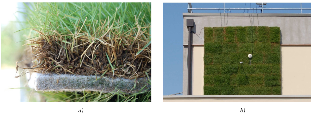
Figura 43 – Dettaglio secondo prototipo di Living Wall monitorato. a) dettaglio substrato; b) installazione su parete
