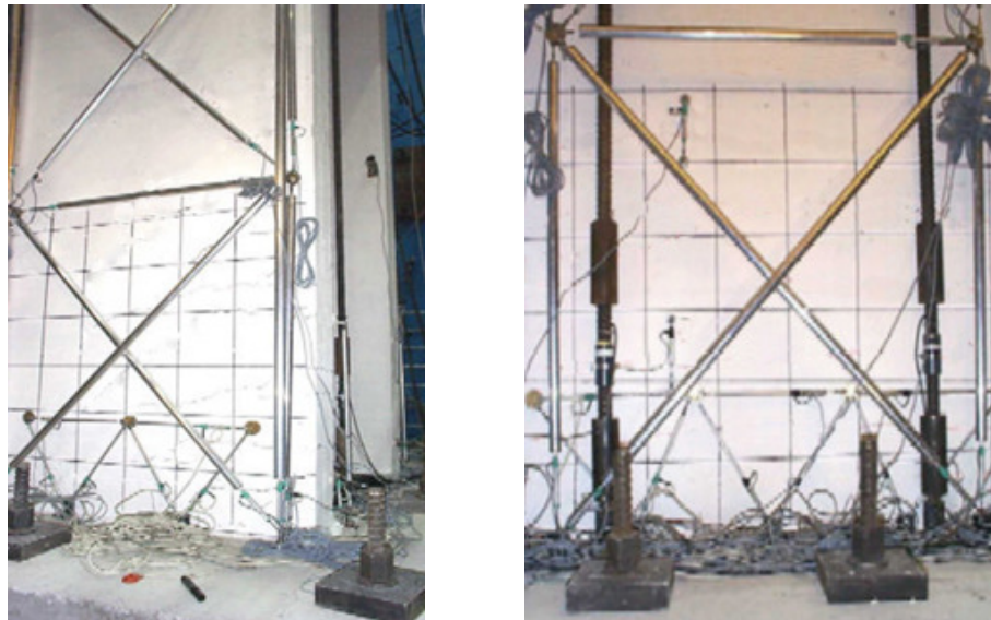
figura 2.80 – Stato fessurativo del provino al termine del ciclo n°1 (ampiezza 3.70mm) [2.22]
