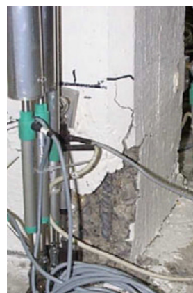
figura 2.84 – Espulsione del copriferro alla base al termine del ciclo n°4 (ampiezza 40.00 mm) [2.22]
