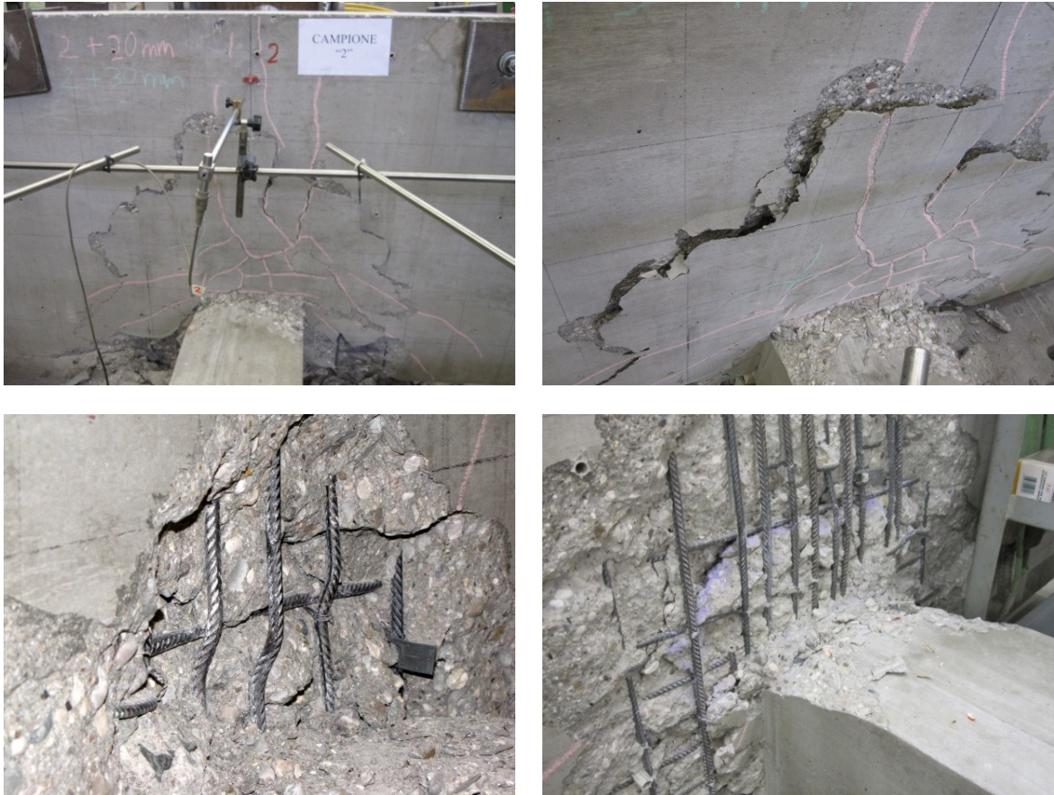
figura 4.29 – Foto del provino S2 al completamento della prova
