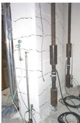
figura 2.83 – Stato fessurativo sulla flangia al termine del ciclo n°4 (ampiezza 40.00 mm) [2.22]
