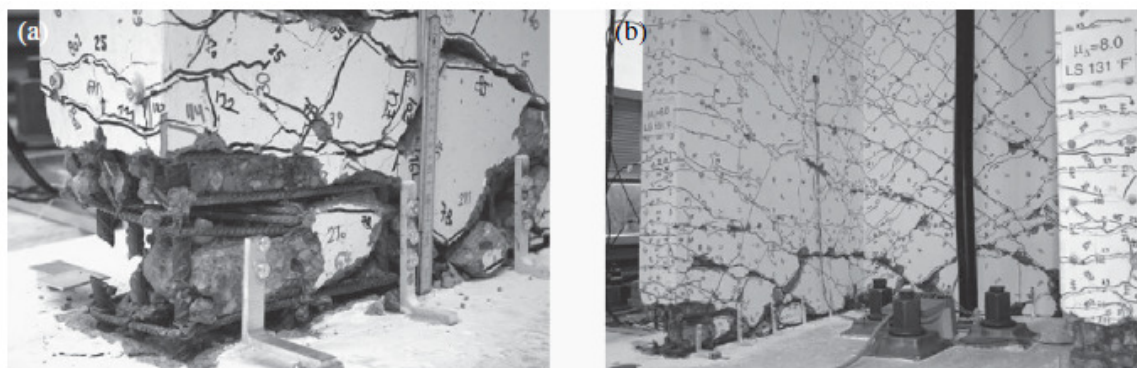
figura 1.16 – (a) Collasso del provino TUA a duttilità 8. (b) Rottura delle barre D12 in posizione F; fessurazione del provino [1.62]
