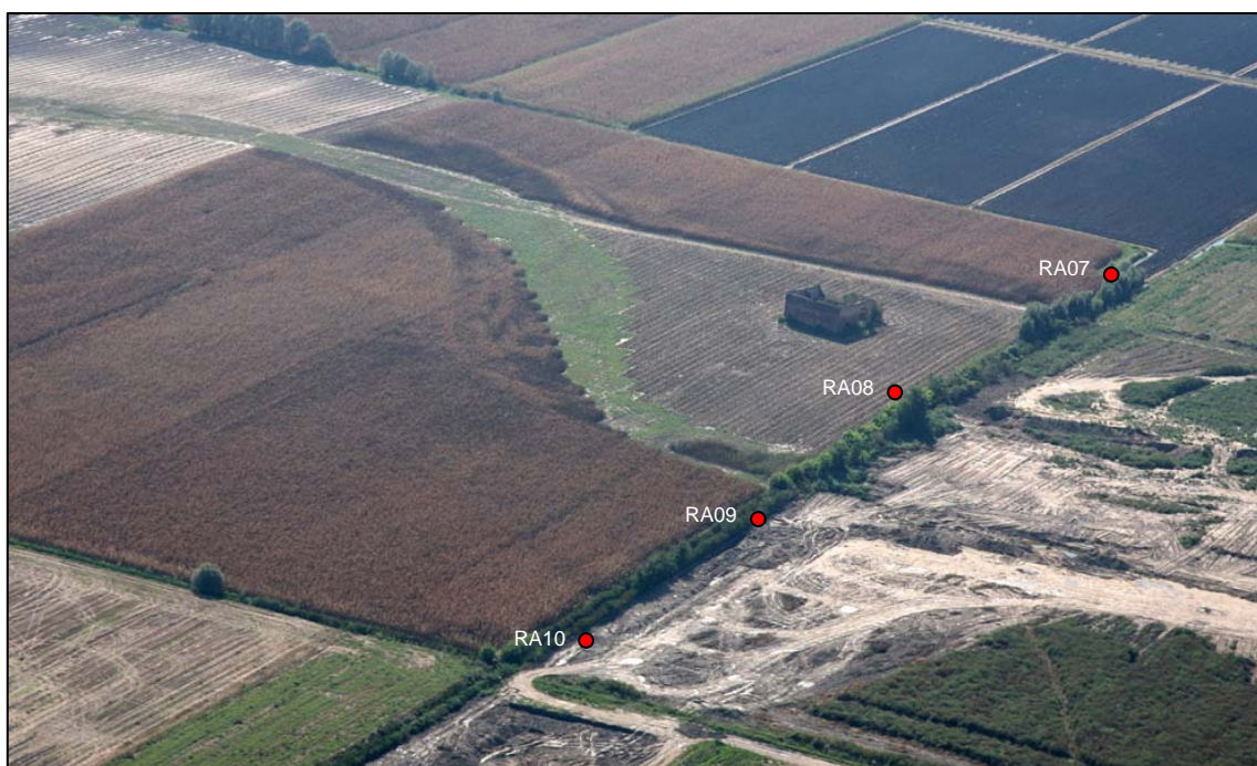
Fig. 53 – Traccia del dosso fluviale che corre 1 km a nord dell’Adigetto presso Fasanara. Si possono notare, dove non ancora intaccate dalle migliori fondiari, le tracce di accrescimento laterale delle barre fluviali. Vengono riportati, in rosso, i punti di sondaggio (transetto Ramalto 1). Foto di A. Ninfo (Progetto ARCUS – via Annia).
