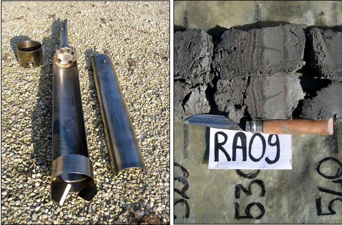
Fig. 25 – A sinistra, foto del carotatore cilindrico e, a destra, esempio di carota estratta con lo stesso. Si nota la preservazione della struttura laminare del sedimento estratto.
