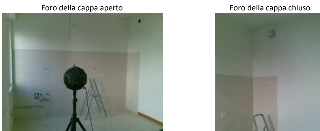
Figura 6 – Immagini delle misure in uno degli ambienti F, con foro della cappa aperto e chiuso
