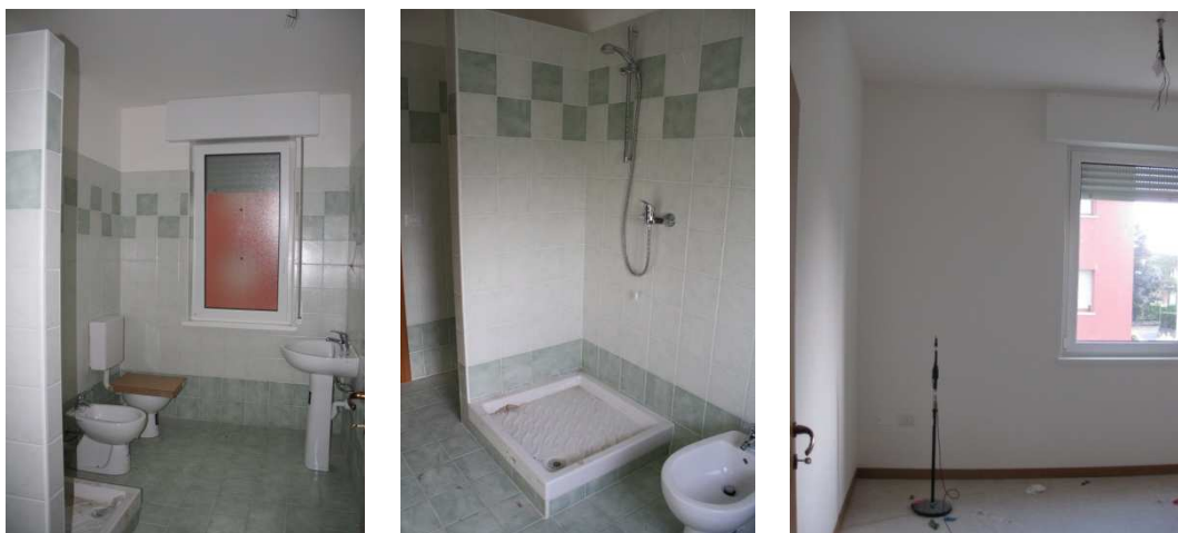
Figura 43 – Immagini delle misure nei bagni della palazzina E1. A partire da sinistra: uno dei bagni, il particolare di una delle docce (priva del box), ed un esempio di posizionamento del microfono per la misura d’angolo.
