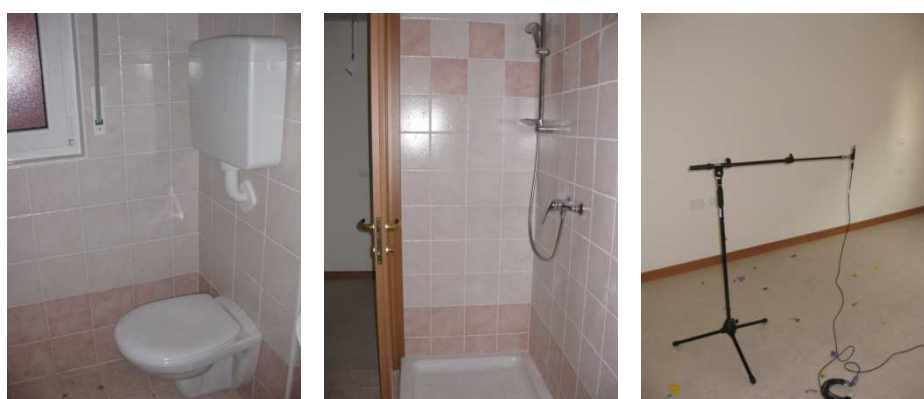
Figura 48 – Palazzina D, immagini di wc e doccia di uno dei bagni ed esempio di posizionamento del microfono per una misura in campo diffuso
