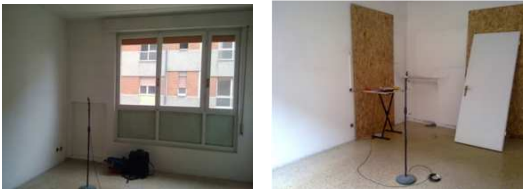
Figura 18 – Alcune immagini delle misure nell'ambiente D' della palazzina A. Dato che al momento dei collaudi erano già state demolite molte porte interne, sono stati utilizzati dei pannelli di tamponamento per delimitare gli ambienti.
