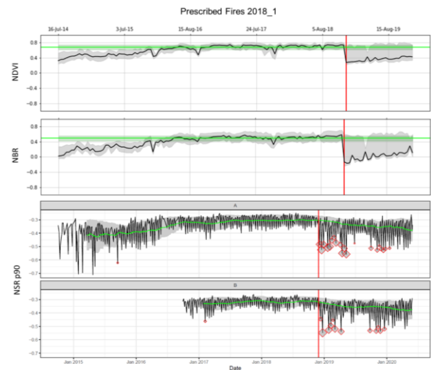
Figura 8. Confronto SAR e indici spettrali; un esempio di corretta identificazione da parte dell'indice SAR (NSR 90° percentile). La linea rossa indica la data dell'incendio.
