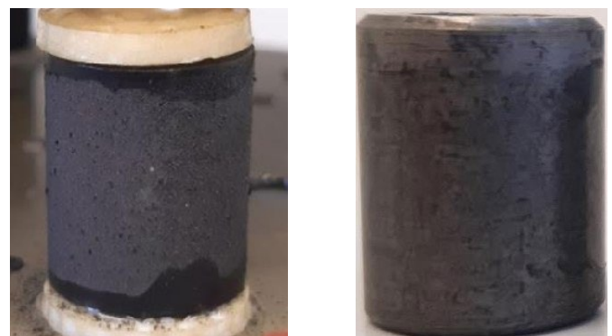
Fig.2 - (a) effetto del tempo di immersione sulla velocità di corrosione dei provini nelle diverse posizioni; (b) aspetto del provino immerso in acqua saturo di CO_2 dopo la prova di 168 h; (c) aspetto del provino dopo la prova in condensa con temperatura del fluido refrigerante 5 °C (t 45 h) / (a) effect of the time of immersion on the corrosion rate of the specimens in different positions (b) specimen tested in CO_2 saturated water after 168 h; (c) specimens after the test in condensed water saturated by CO_2 with temperature of cooling fluid at 5 °C (time of exposure 45 h)
