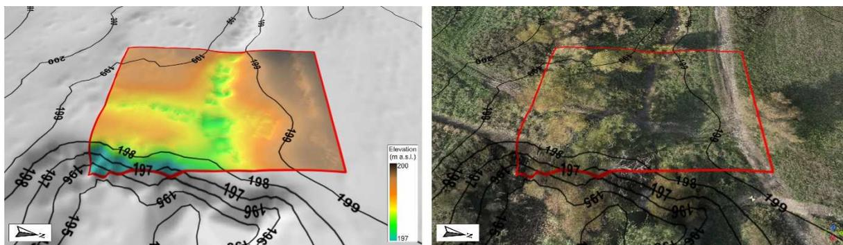
**Figura 19.** Rappresentazione 3D dell'area rilevata con il drone (poligono rosso) su DTM ad alta risoluzione (20 cm) a sinistra e su ortofoto a destra, con quote rappresentate dalle curve di livello.
