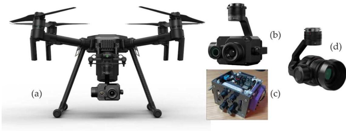
**Figura 13.** Drone DJI Matrice 200 (a), termocamera Zenmuse XT2 (b), camera multispettrale MAIA M2 (c) e camera RGB Zenmuse X5S(d).
