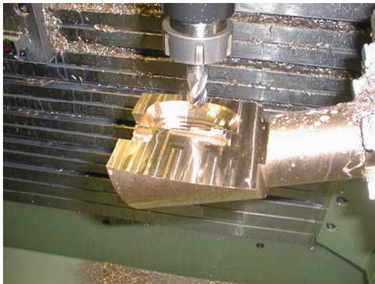
Figura A.1: Realizzazione del cucchiaio di una turbina Pelton per asportazione di truciolo.
